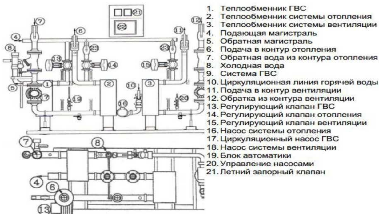
Рисунок 1 - Принципиальная схема индивидуального автоматизированного теплового пункта.
